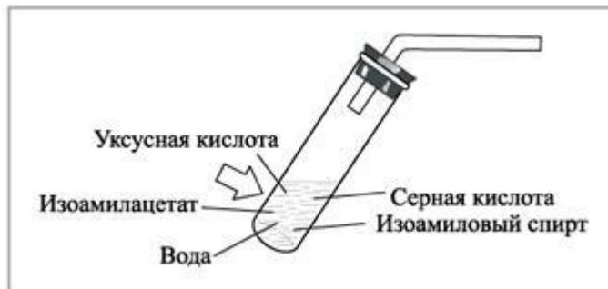
Рис. 1. Пробирка-реактор для получения сложного эфира (изоамилацетата)
